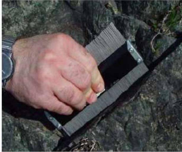
*Figura 3-8: Rilievo di profili con Pettine di Barton. Fonte: Slide prof. C. Scavia*
