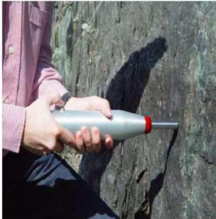
*Figura 3-7: Eseecuzione di una prova sclerometrica. Fonte: Slide prof. C. Scavia*
