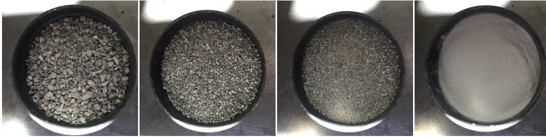
Figura 4.1 le 4 classi di aggregato impiegate: andando da sinistra verso destra si ha il pietrisco, la graniglia, la sabbia e il filler
