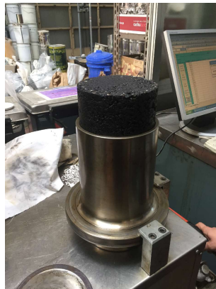
Figura 3.14 estrazione del campione dalla fustella
