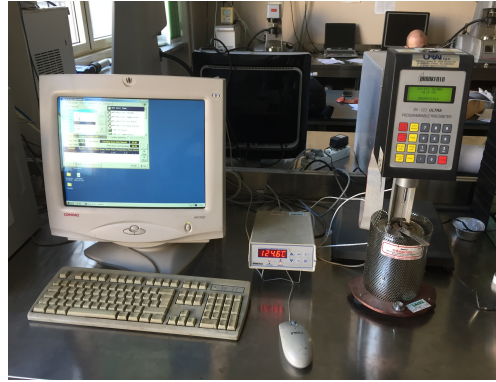
Figura 3.19 Viscosimetro Rotazionale (dx) e sistema di acquisizione dati (sx)
