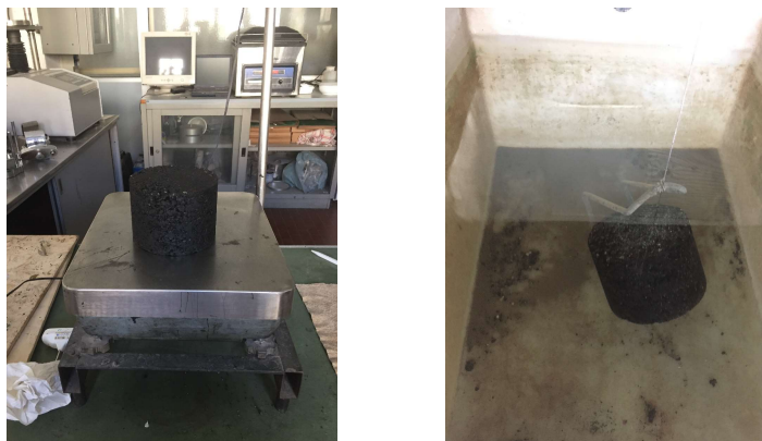
Figura 3.12 massa secca (sx) e massa satura in acqua (dx) di un campione di miscela
