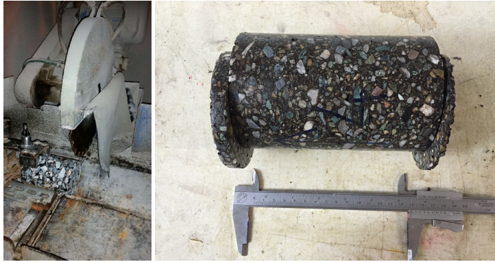
Figura 4.10 macchina troncatrice e campione tagliato
