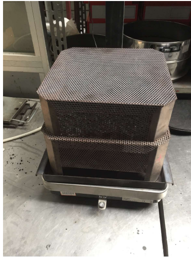
Figura 3.5 cestello d'acciaio utilizzato per la prova
