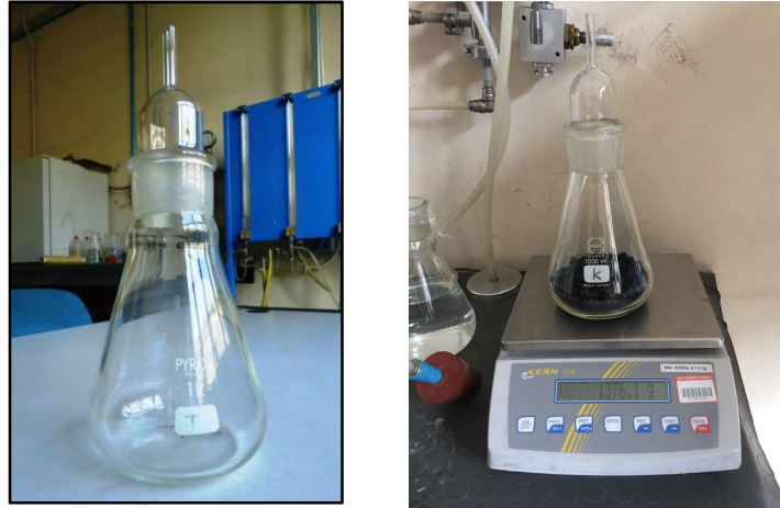
Figura 3.9 picnometro vuoto e picnometro pieno
