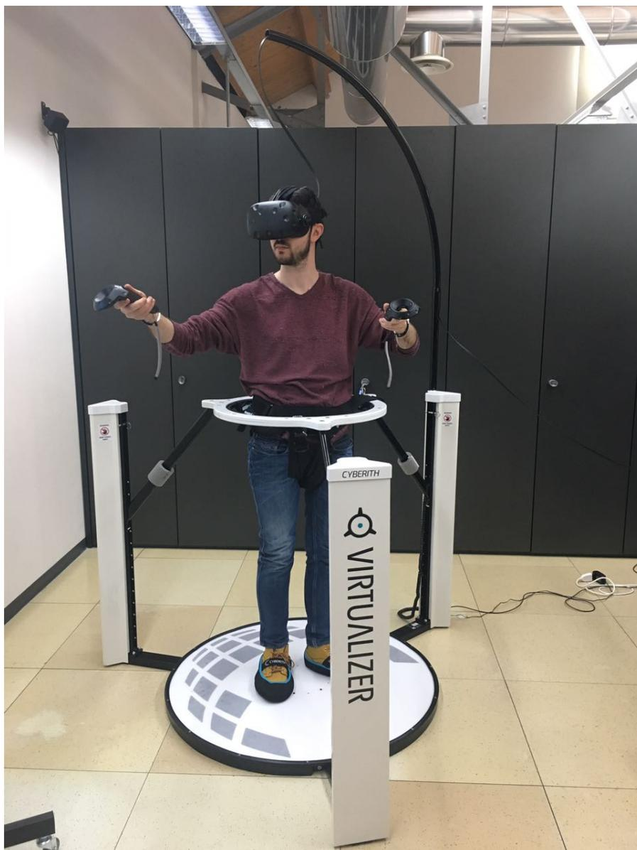
Figura 3.4: Pedana Cyberith Virtualizer, integrata con HTC® Vive™
