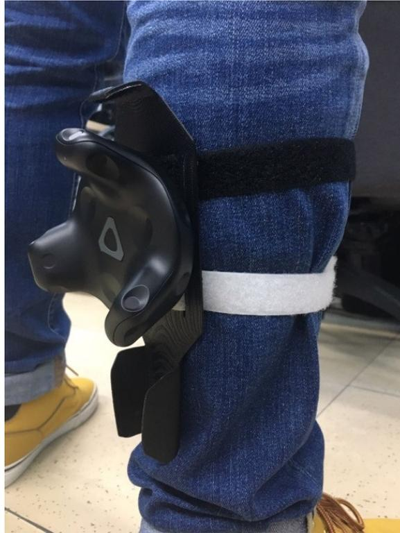
Figura 3.2: HTC® Vive™ Tracker con supporto per essere fissato alle gambe
