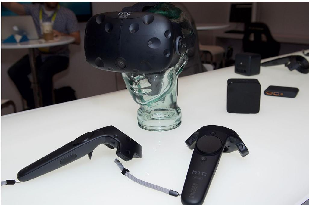
Figura 3.1: HTC® Vive™ HMD con controller e stazioni base
