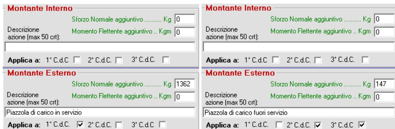
Figura 72 – Azioni esplicite sui montanti ponteggio Nord-Ovest
