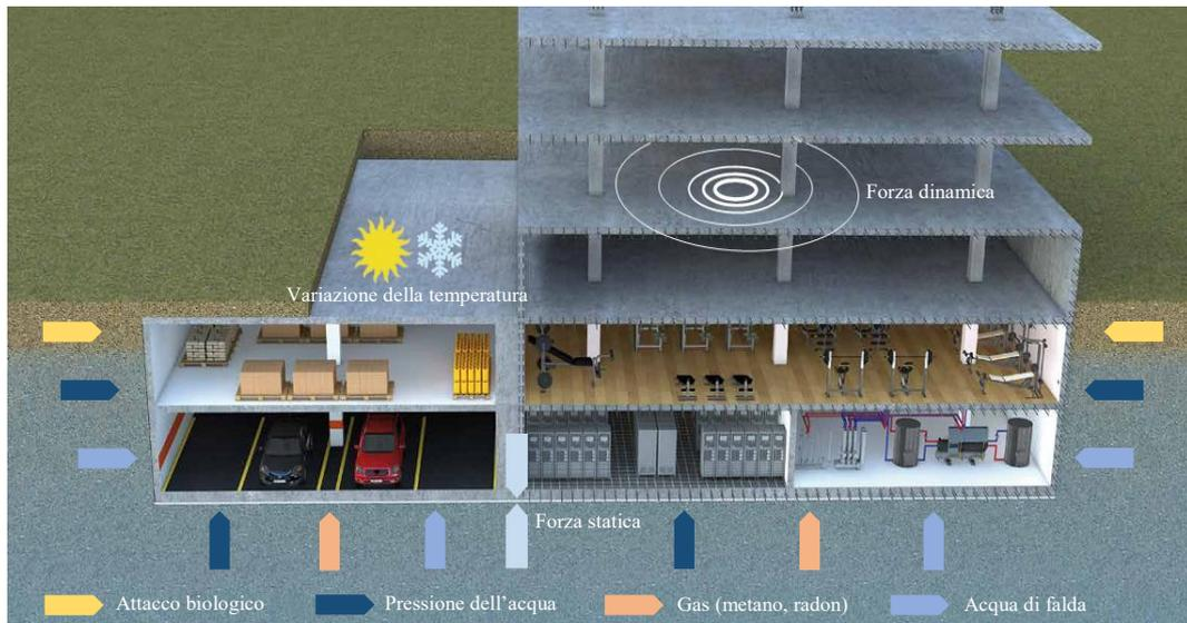
Figura 1: Esposizione e sollecitazioni (Fonte / Sika, Soluzioni per strutture interrate in calcestruzzo)
