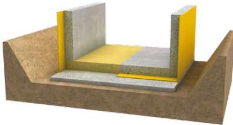
Figura 16: Scavo non confinato (Fonte / Sika, Soluzioni per strutture interrate in calcestruzzo)
