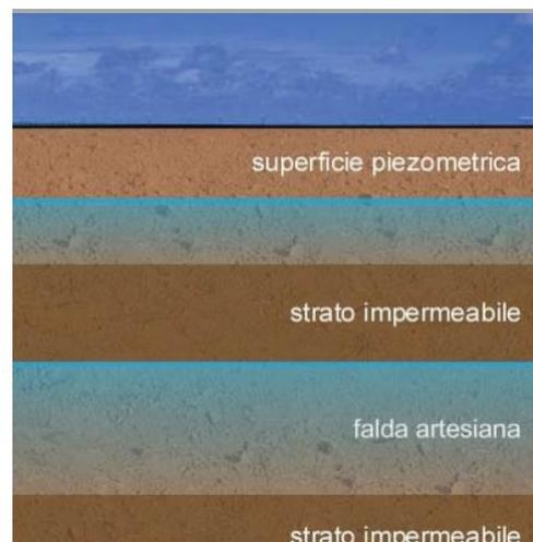
Figura 4: Sezione di terreno in presenza di falda artesianica (Fonte / Mapei, Impermeabilizzazione di strutture interrate)
