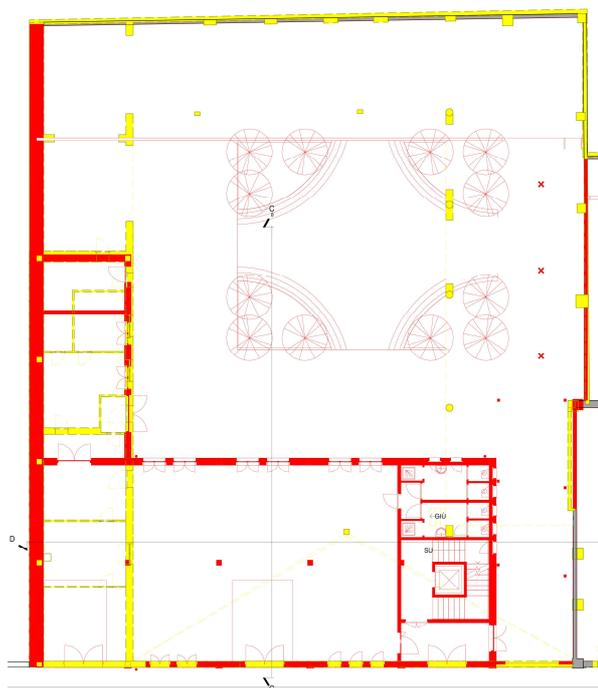
Figura 25 - Demolizioni e Costruzioni Edificio Atelier (Tav. n°5 scala 1:100)
