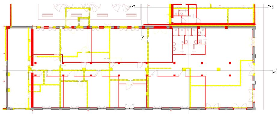
Figura 34 - Demolizioni e costruzioni Fab-lab (Tav. n°5 scala 1:100)
