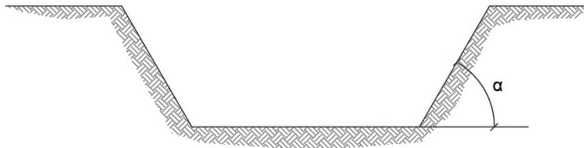
Figura 1.1 Fronte di scavo con pendenza
