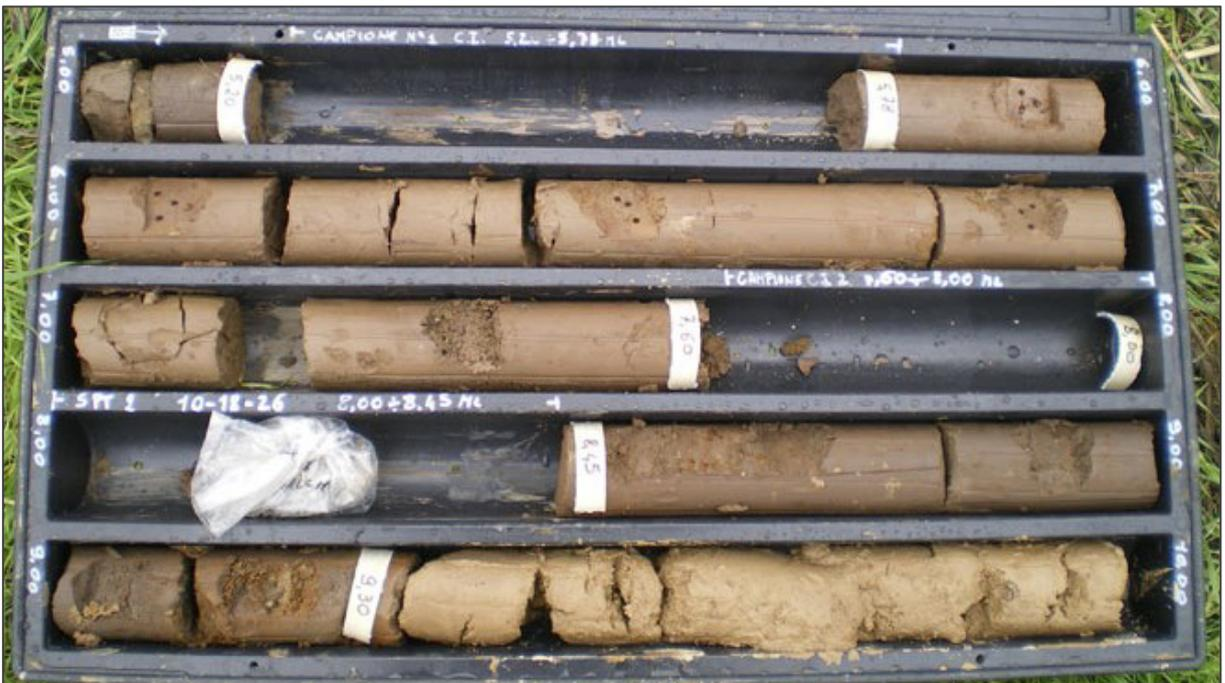
Figura 3.4 Cassetta catalogatrice di carote di terreno (www.icofond.com)
