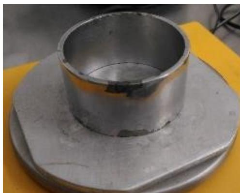
Figura 28. Cilindro utilizzato per il calcolo del peso specifico.
