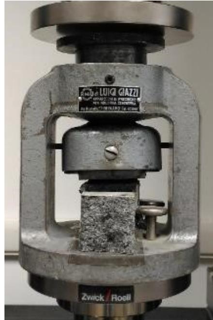
*Figura 32. Supporto metallico utilizzato per la prova a compressione.*
