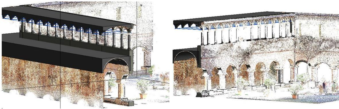
Figura 9.22- Creazione delle volte a crociera mediante il solido di sottrazione
