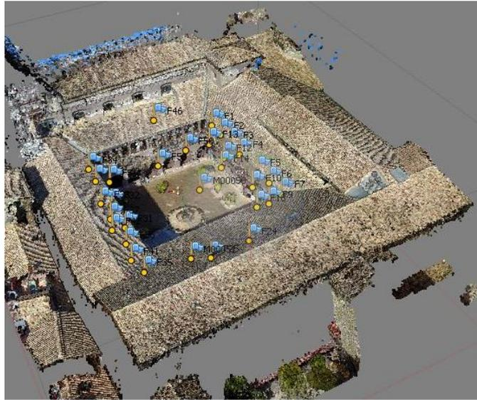
Figura 6.60- Nuvola densa, chiostro Tolentino, ottenuta dopo l'unione dei due chunks con marker
