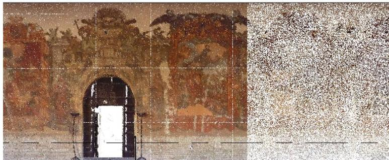
Figura 9.11- Ortofoto generata a sinistra, a destra la nuvola di punti utilizzata per generare l'ortofoto.
