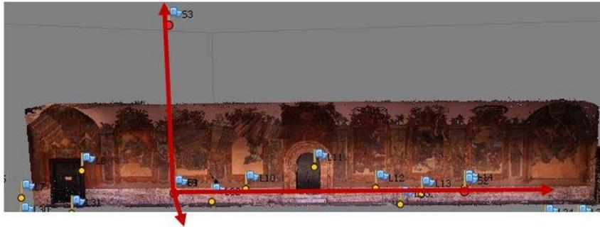
Figura 6.49- Modello tridimensionale con marker creati per generare il prospetto
