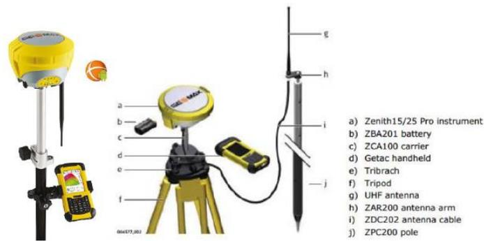
Figura 5.2- Strumento GeoMax, palina e base
