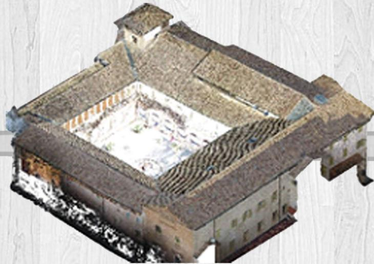
Livello corrispondente alla fase di rilievo condotta con diverse tecniche, quali fotogrammetria con UAV e laser scanner.
