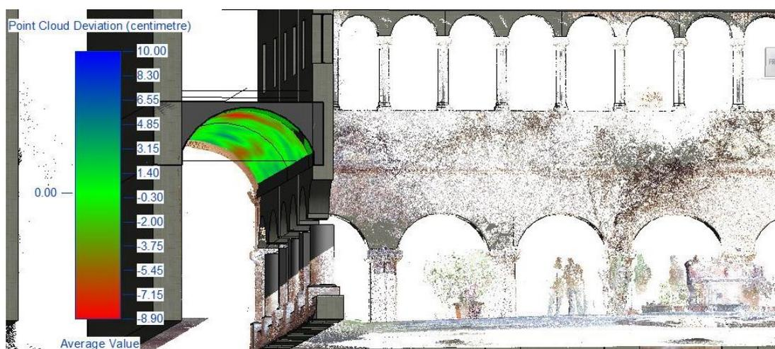
Figura 9.23- Esempio di confronto tra la volte a botte ovest e la nuvola di punti
