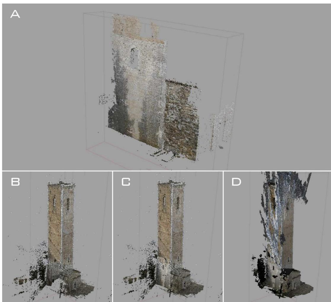
Figura 93: a) nuvola sparsa del chunk 1, b) nuvola sparsa del chunk 2, c) nuvola sparsa del chunk unione, d) nuvola densa del chunk unione.
