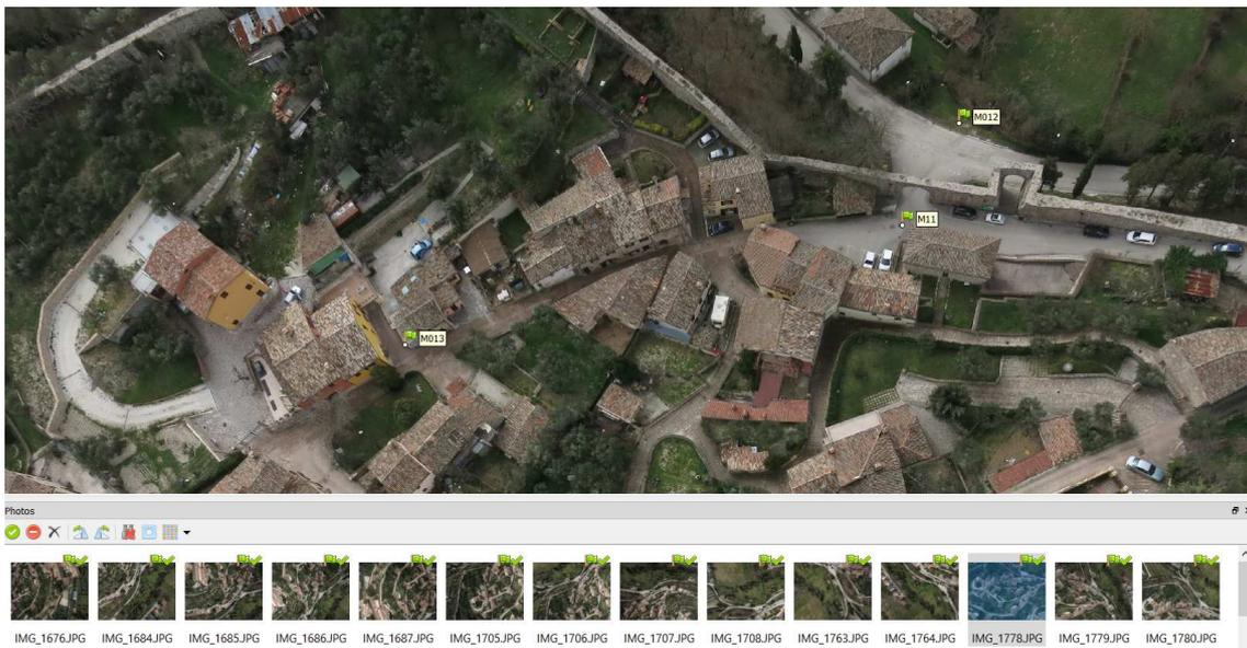
Figura 29: collimazione manuale assistita dei *GCP* dell'area del colle Monte Nero. Elaborazione compiuta con il software Agisoft Photoscan.
