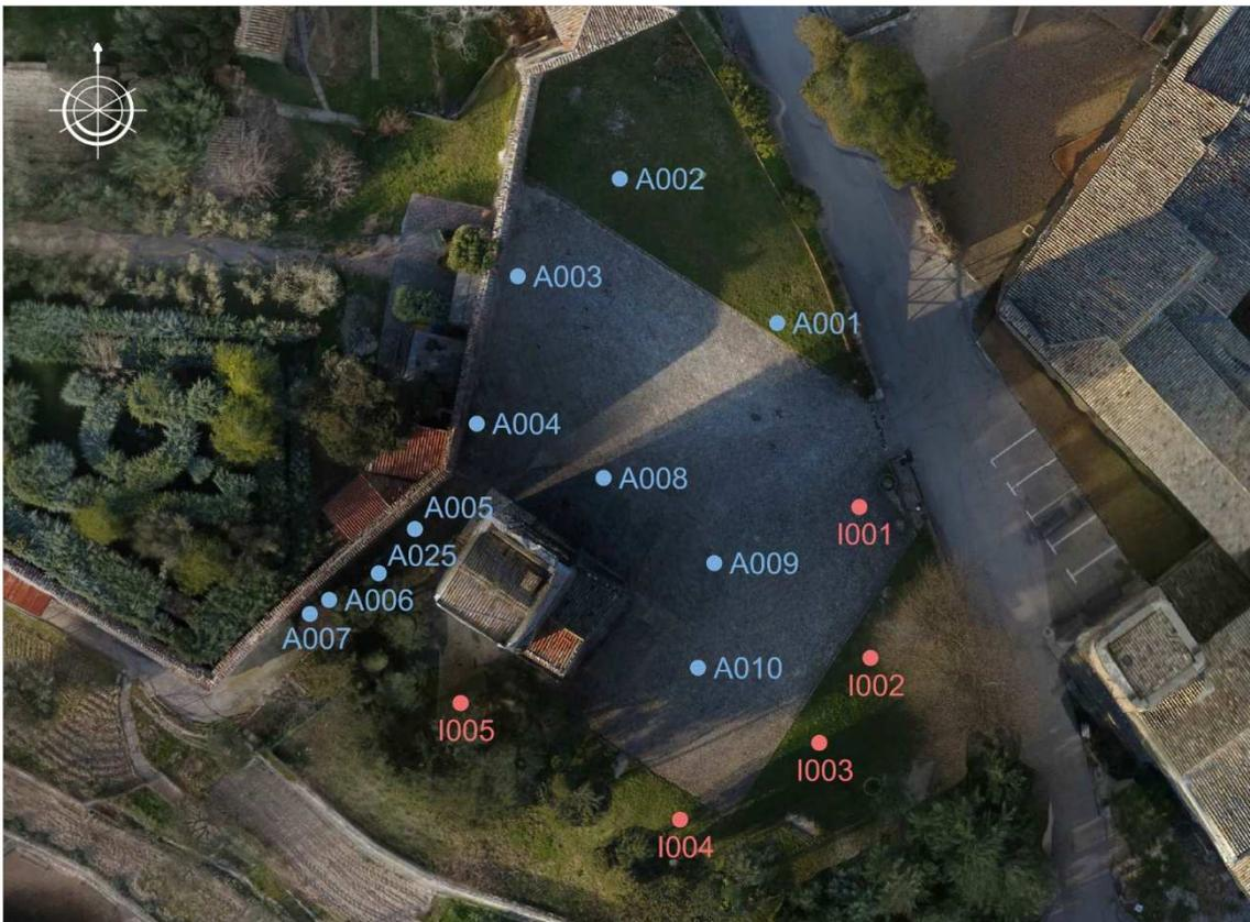
Figura 98: localizzazione delle scansioni acquisite in loco. In blu quelle rilevate dalla stazione del DAD, in rosso quelle rilevate dalla stazione del DIATI.
