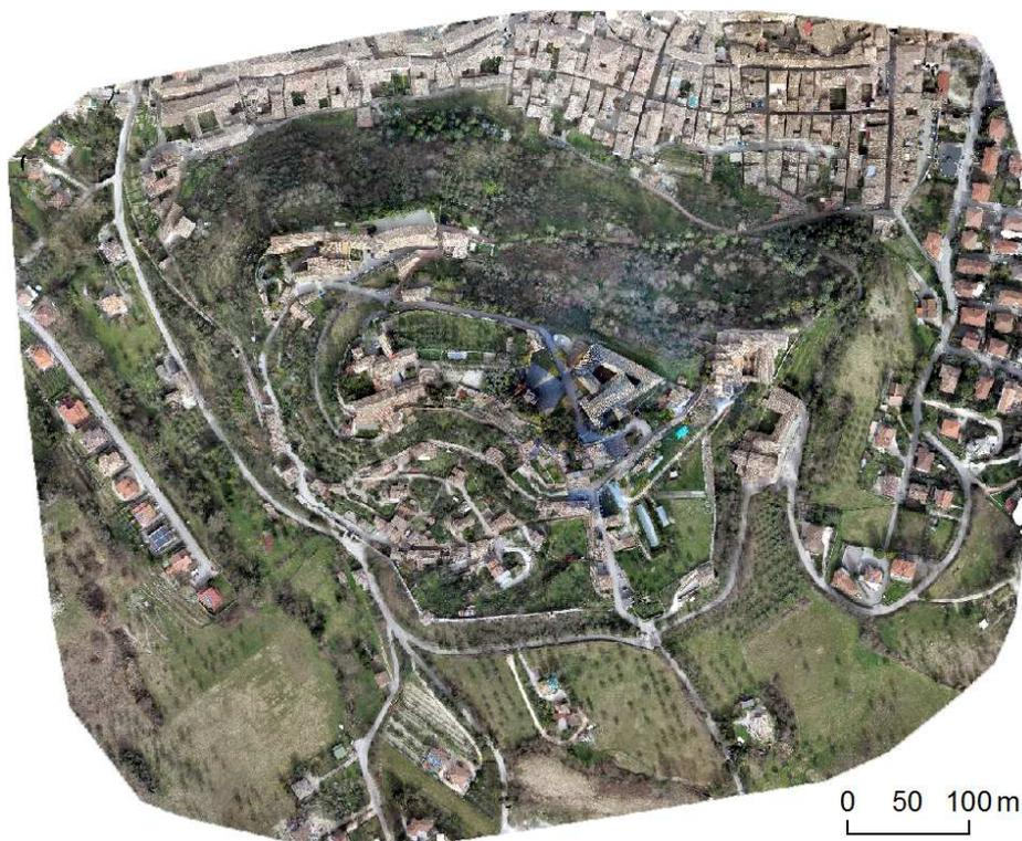
Figura 75: Ortofoto del colle Monte Nero ottenuta col file di progetto 3 relativo all'unione delle due prese aeree effettuate con drone multirottore Phantom 4 e drone ad ala fissa eBee.
