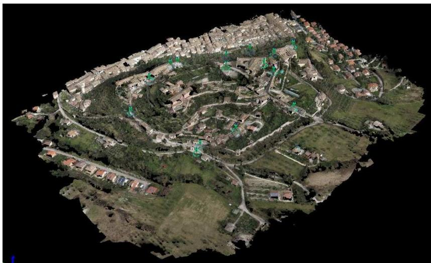
Figura 72: nuvola densa del file di progetto 1 (volo *eBee*) con in evidenza il posizionamento spaziale dei marker.
