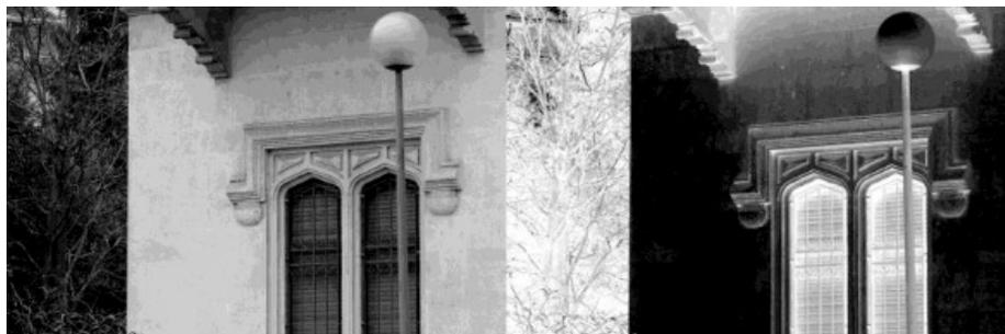
Figura 23: applicazione dell'operatore LoG. Fonte: A. M. LINGUA, *Fotogrammetria digitale...*, p. 7.
