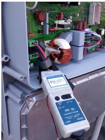
Fig.5.2 sonda di corrente lato DC interno all'inverter
