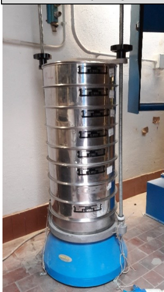
Figura 5—4. Macchina Vibrovagliatrice, utilizzata durante la setacciatura meccanica dei campioni.
