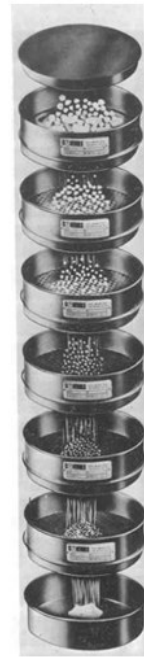
Figura 2—3. Esempio di setacci impilati secondo l'ordine decrescente di apertura delle maglie.
