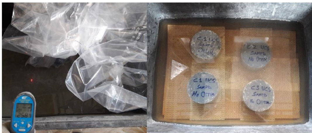
Figura 11—4. Condizionamento dei provini cilindrici (sinistra) in sacchi chiusi immersi in acqua per 7 giorni e successivamente (destra) immersi in acqua per 4 ore.
