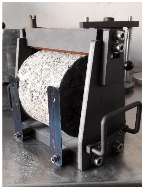
Figura 12—3. Posizionamento del campione all'interno della castellatura, con interposizione delle fascette in legno (sopra).
