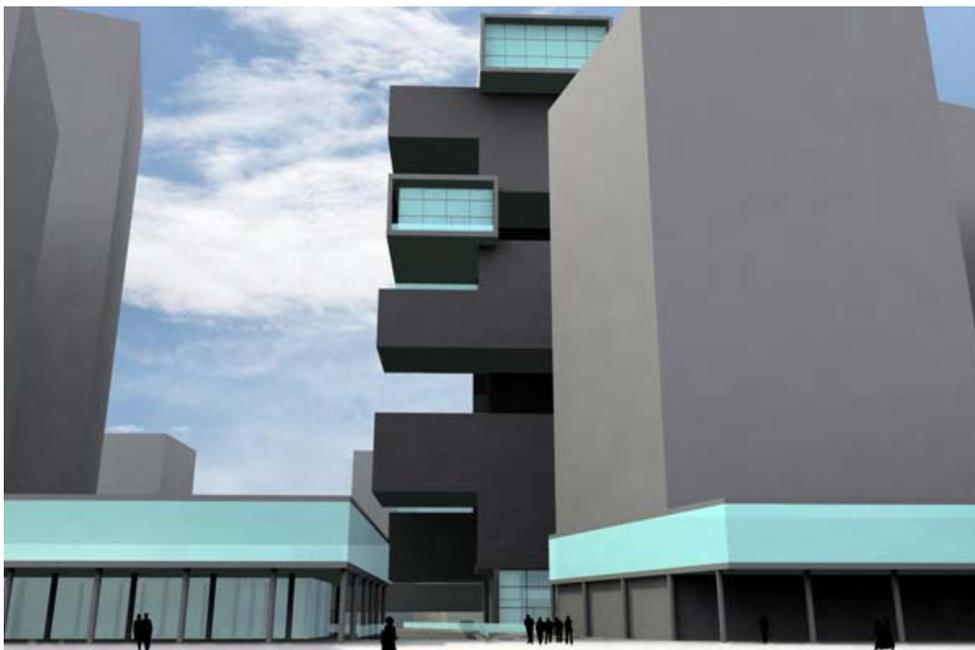
Il controllo climatico delle scatole avviene tramite ventilazione naturale: aperture con lamelle computerizzate nelle vetrate che chiudono i lati corti delle scatole utilizzando il **sistema a dislocamento**, con l'immissione dal basso e la ripresa dall'alto, assicurano aria pulita a livello delle persone.
