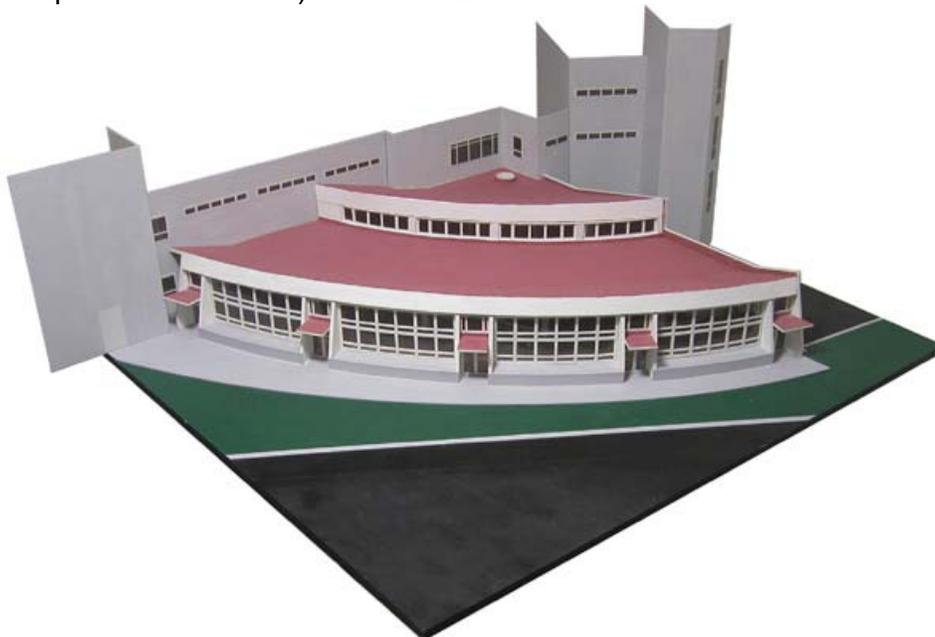
Il cielo artificiale consente di effettuare valutazioni quantitative: i dati rilevati da sonde luxmetriche vengono elaborati per rappresentare i livelli di luce mediante curve isovalore in pianta e andamenti in sezione e nel tempo.
