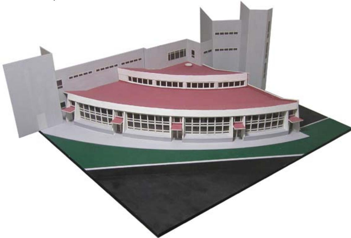
El cielo artificial permite efectuar valoraciones cuantitativas: los datos adquiridos por sondas luxmétricas son elaborados para representar los niveles de luz mediante curvas isovalor en planta y evolución en sección y en el tiempo.
