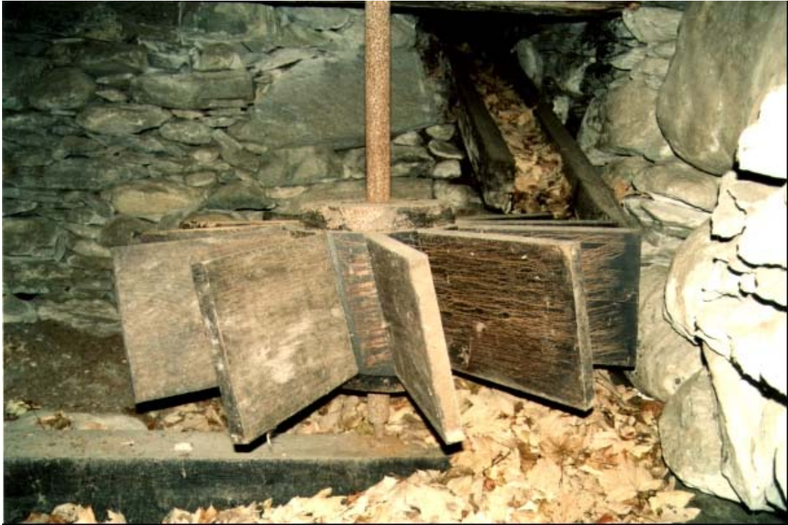
Ruota idraulica orizzontale del mulino del Piccolo Passet (Comune di Massello)
