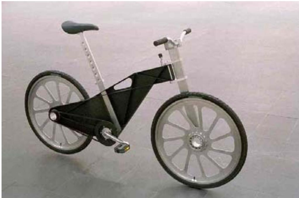
Il telaio strutturale può essere considerato il simbolo di di questo tentativo, essendo stampato in una singola operazione che fornisce un pezzo finito pronto per essere assemblato. Usando la tecnologia delle strutture in tecnopolimero, abbiamo disegnato un pezzo dall' aspetto rude che offre in cambio un' ottimo comportamento statico in un peso molto contenuto.
