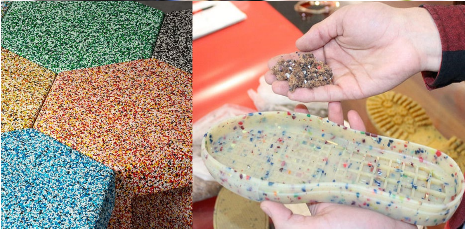
Figura 2.5 I processi di recupero materico attualmente più diffusi permettono un reimpiego in nuove soles e solette di scarpe, tappeti antiurto, arredi urbani o come carica inerte in ambito edilizio [17-19].
