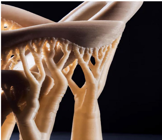
Figura 4.34 La bioplastica BioCirfflex è disponibile sotto forma di pellet o filamento, risultando adatta sia a processi produttivi tradizionali che all'AM [168].
