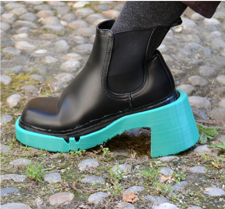
Figura 7.17 e 7.18 Immagine del sistema durante la fase di testing su un terreno irregolare costituito da ciottoli e nei test di rimozione.
