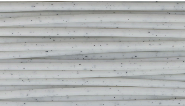
Figura 4.31 Sulla superficie dei componenti stampati con il Recreus Filaflex Purifier Mineral sono osservabili le particelle addizionate all'elastomero [162].
