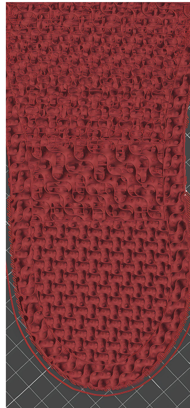
Figura 8.4 Il riempimento dei prototipi è stato impostato dal software di slicing mediante l'uso di modificatori.
