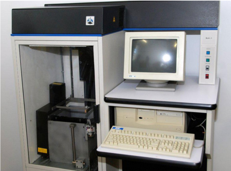
Figura 4.2 La prima macchina SLA, sviluppata da Chuck Hull e commercializzata dal 1986 con l'azienda 3D Systems [75].
