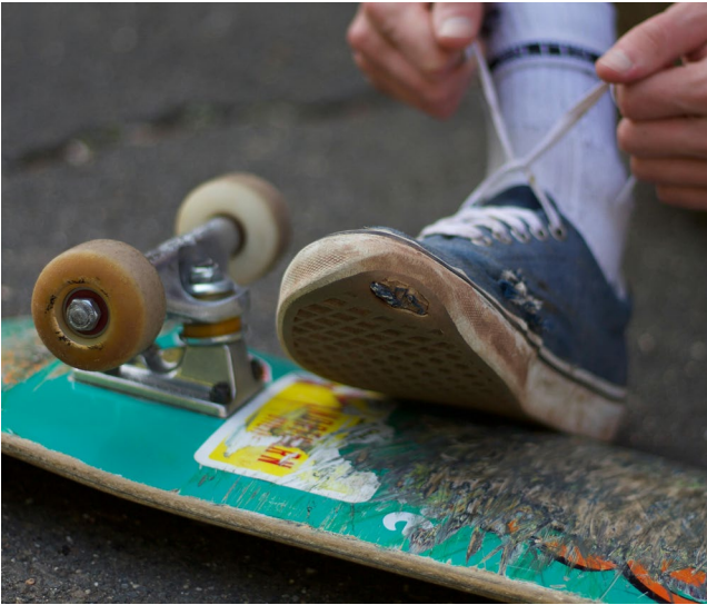
Figura 6.2 L'esecuzione di trick con la tavola da skate determina spesso un'usura localizzata in poche specifiche aree della scarpa, richiedendo perciò riparazioni temporanee o la sostituzione dell'intero prodotto [207].
