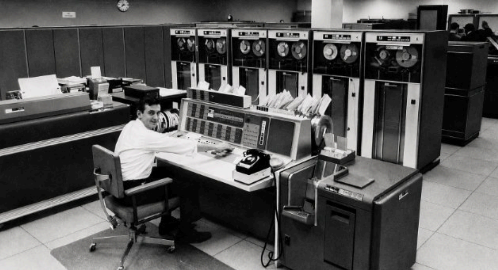
Figura 1.14: Il mainframe IBM 7094 (qui in una foto d'archivio della Columbia University), tipico esempio dei calcolatori degli anni '60 53 .
