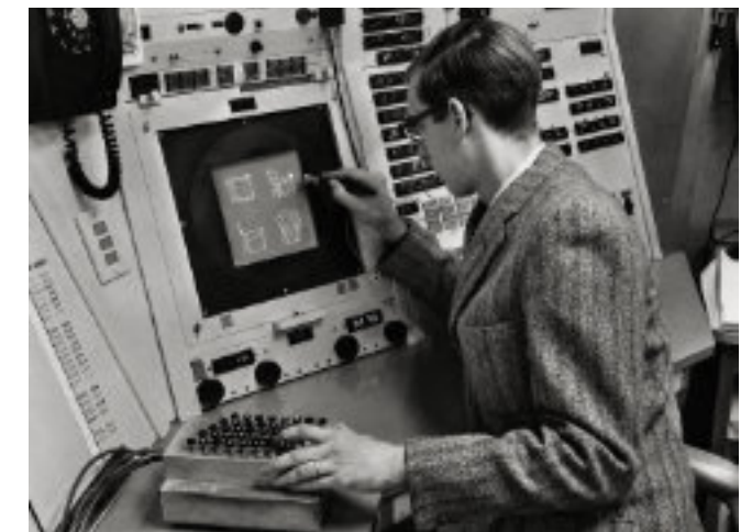
Figura 1.15: Ivan Sutherland mentre opera sul sistema Sketchpad nel 1963 presso l'MIT, utilizzando una penna ottica per interagire direttamente con lo schermo 58 .
