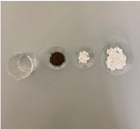
Fig. 24) Soluzione di Potassio, Steel Slag, Idrossido di Calcio e Calcite
