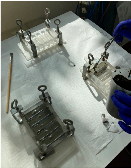
Fig. 30) Getto della pasta cementizia all'interno dei casseri
