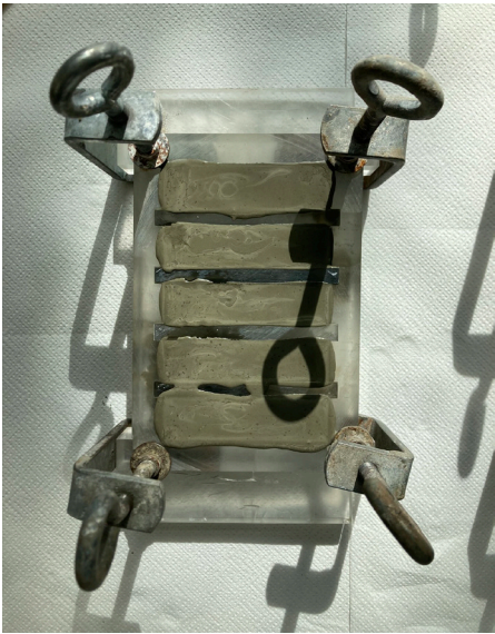
Fig. 31) Stagionatura della pasta cementizia per 24h
