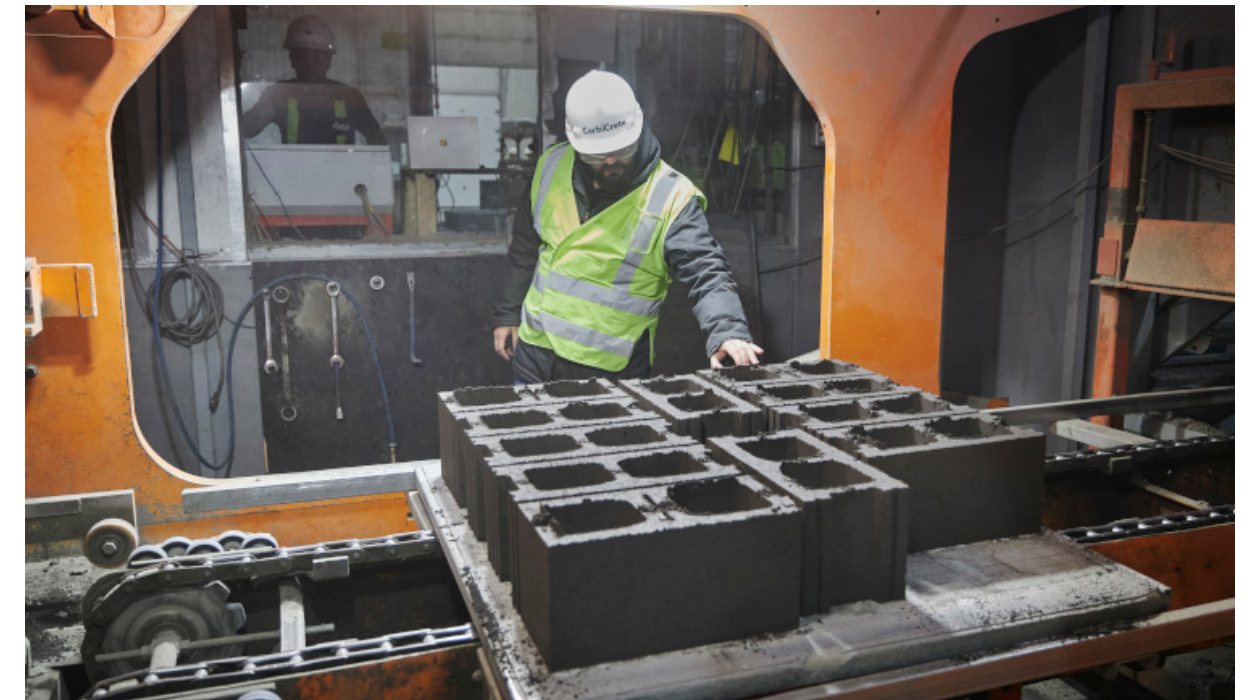
Fig.10: Produzione di blocchi "cement free" presso lo stabilimento di produzione dell'azienda "Patio Drummond" in Quebec. Fase di carbonatazione all'interno di camere controllate. Fonte: Patio Drummond
