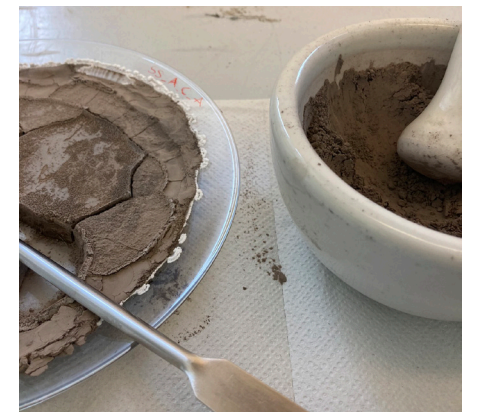
Fig. 13) Il composto a seguito della centrifuga e della stagionatura
