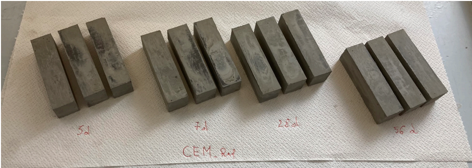
Fig. 32) Provini scasserati prima di essere immersi in acqua
