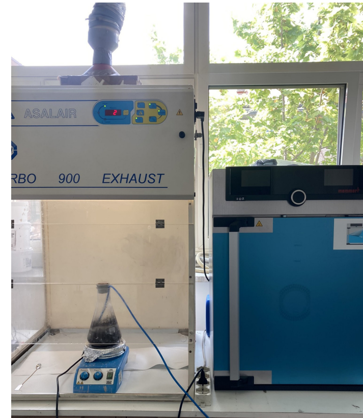
Fig. 11) Il composto è in fase di carbonatazione sotto aspirazione
