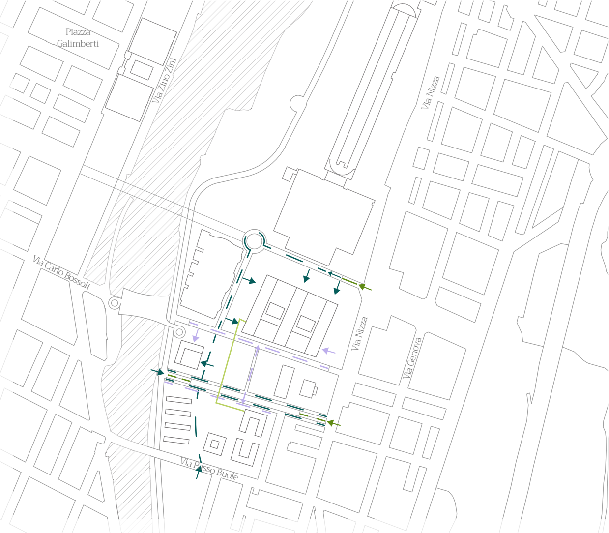
Fig. 78 - Opzione 2.1: Ipotesi dei flussi per la viabilità di superficie dell'area di progetto, Giugno 2026. Elaborazione delle autrici.
