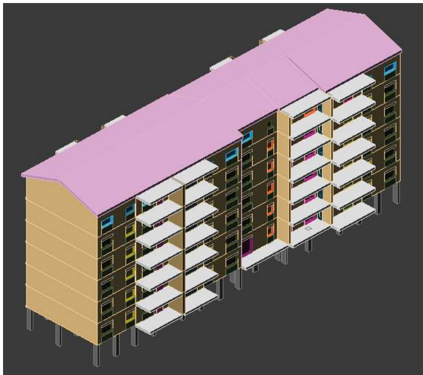
Figura 2.1 — Modellazione energetica dell'edificio in Edilclima EC700. Schermata del modello tridimensionale utilizzato per la costruzione degli scenari energetici di confronto. Fonte: elaborazione propria mediante Edilclima EC700.
