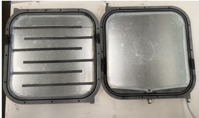
Figura 3.9: Canale di alimentazione (a sinistra) e quello di raffreddamento al termine dell'assemblaggio
