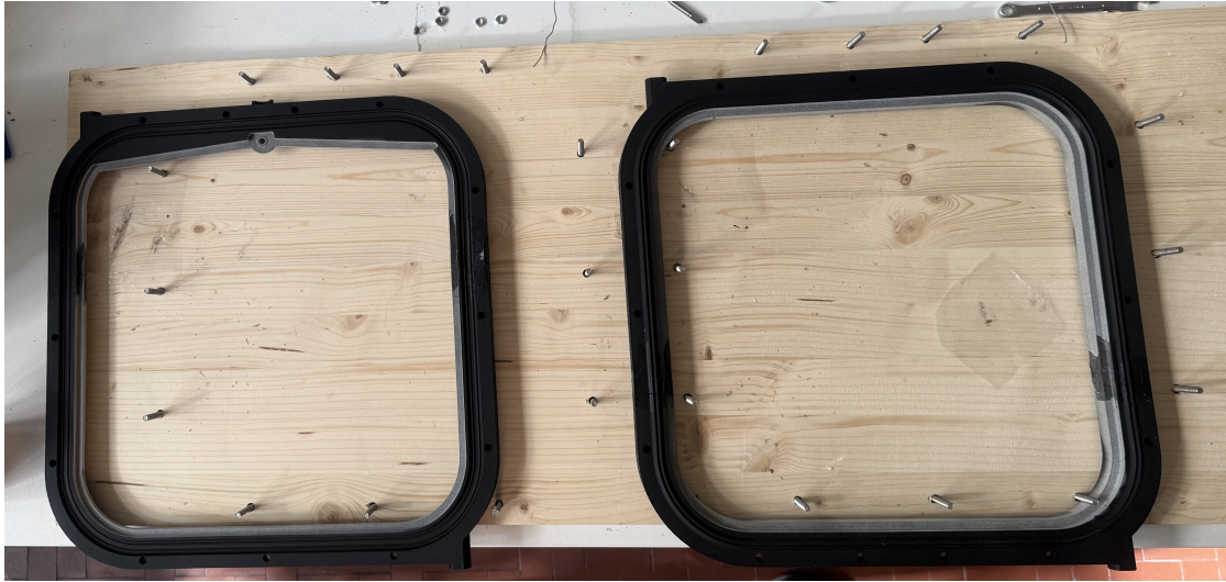
Figura 3.3: Fase di asciugatura del telaio lato feed
