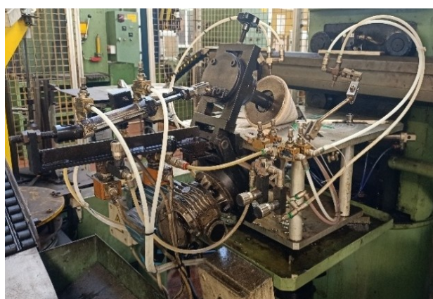
Figura 5.7 – Postazione di Lubrificazione attuale, integrata al sistema “alza e sposta” (a destra)
