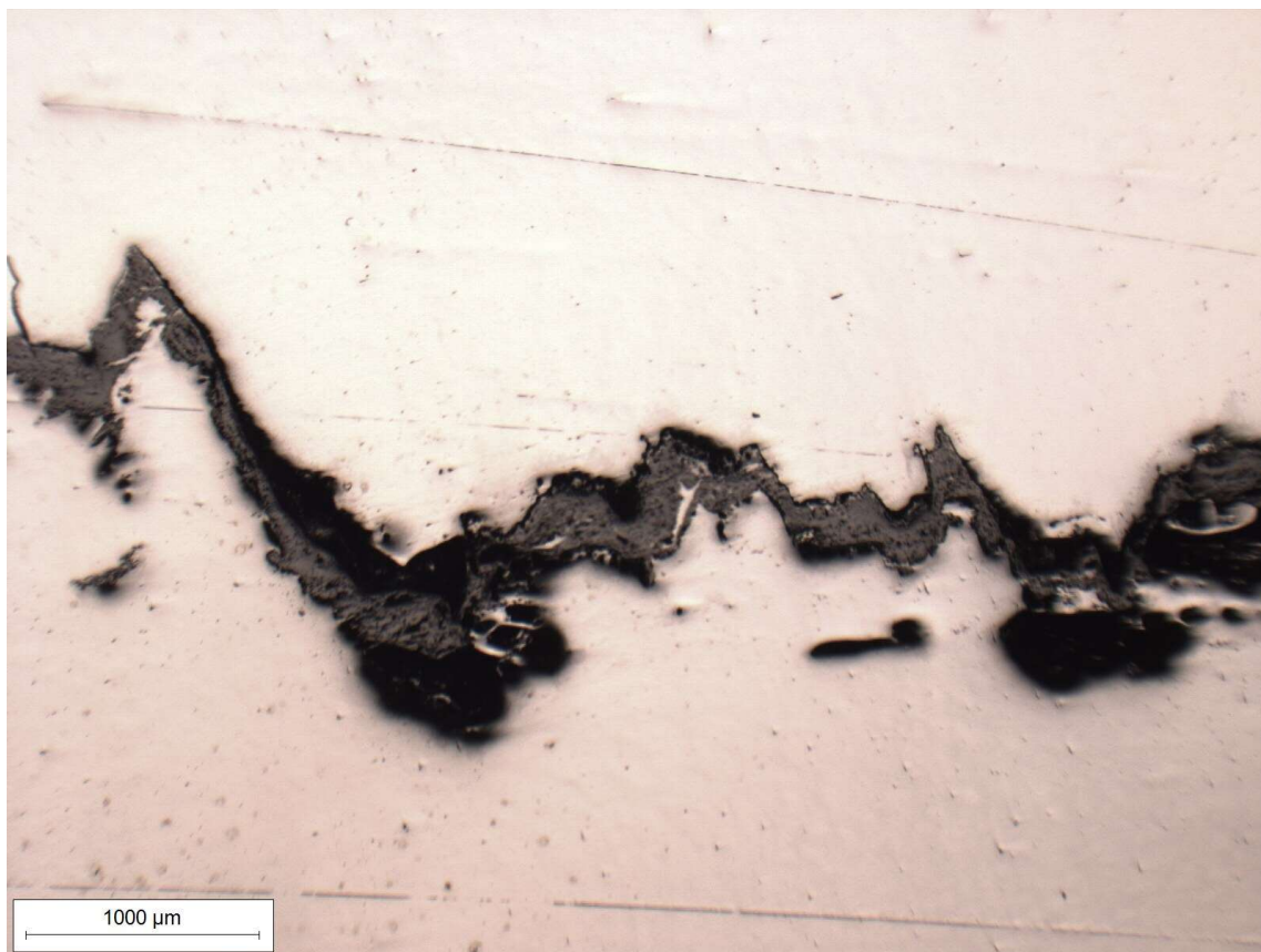
Figura 8.4 – Articolo 080.91 lato numeri: individuazione della discontinuità, acquisita a 2×0,8.
