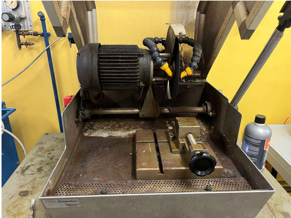
Figure 7.1 Sega troncatrice utilizzata per il taglio dei pezzi forgiati al fine di ottenere i campioni della misura idonea per l'inglobamento
