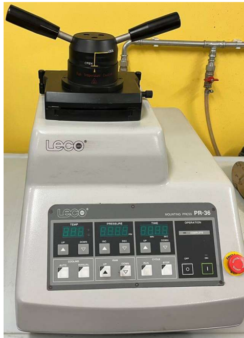
Figure 7.4 – Pressa utilizzata per l'inglobamento a caldo dei campioni prelevati da componenti forgiati. Marca "LECO", Modello "Mounting Press PR-36"
