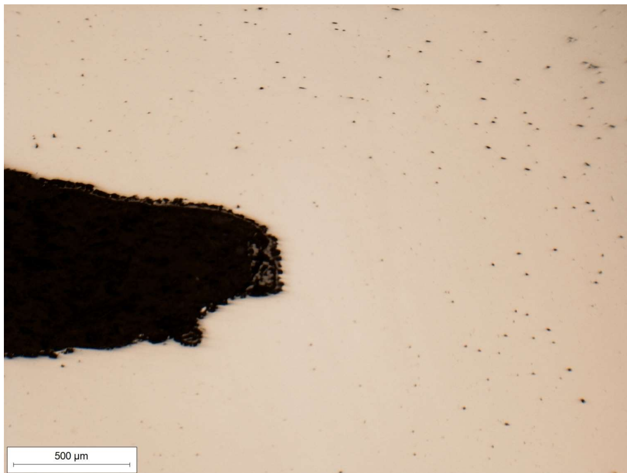
Figure 8.14 - Articolo 5623: approfondimento del difetto a medio ingrandimento, acquisita a 5×0.8.
