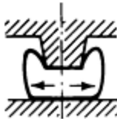
Figure 4.3 – Cricca longitudinale con pezzo vincolato lungo la direzione del difetto [4]
