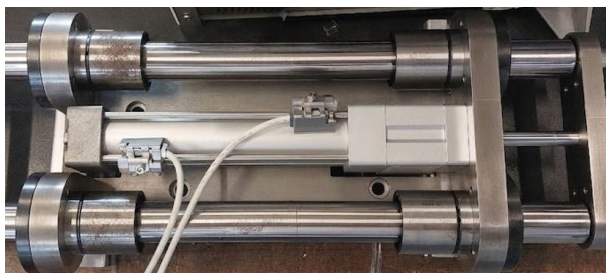
Figura 64: Due finecorsa montati sull'attuatore
