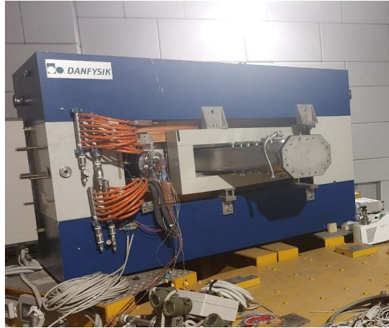
Figura 10: Il dipolo, Laboratori Nazionali del Sud
