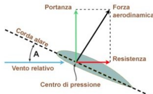
Figura 3.1: Forza aerodinamica sul profilo alare [11]
