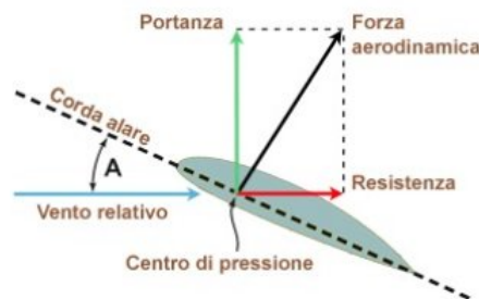
Figura 6.11: Schema delle forze sul profilo alare [11]
