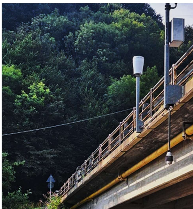
Figura 30- Dettaglio stazione ARPA
