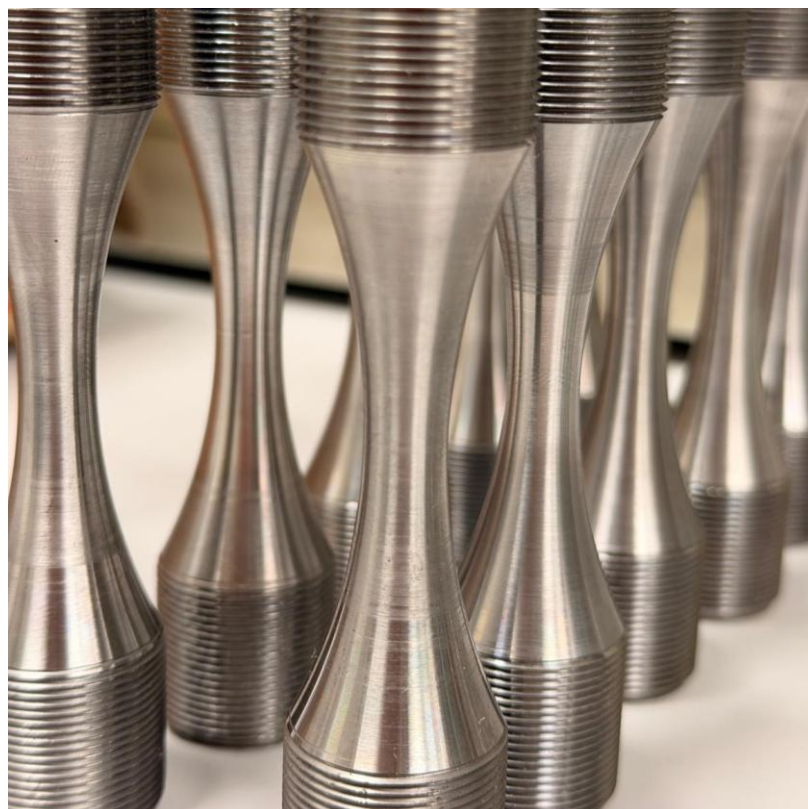
Figura 4 Finitura superficiale dei provini
