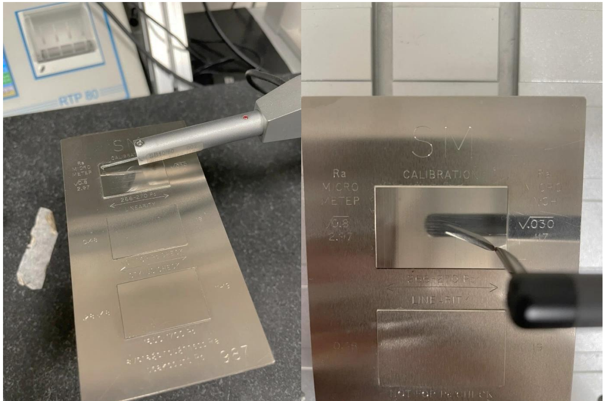
Figura 9 Piastra di calibrazione SM per confronto Rugosimetro(sinistra) e Profilometro(destra)
