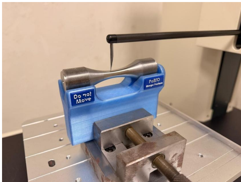
Figura 11 Supporto per vincolare i provini
