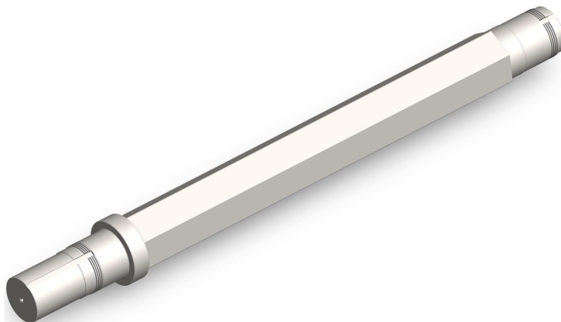
Figura 3.5: Modello CAD dell'albero portacoltelli, con tratto centrale a sezione esagonale destinato al montaggio della sequenza cutter–distanziali e zone terminali a sezione circolare.
