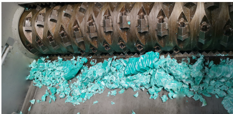
Figura 2.4: Coltelli di una macchina di triturazione e frammenti di plastica prodotti dal taglio. Fonte: Wikimedia Commons, Soddaa, CC BY-SA 4.0 [9].
