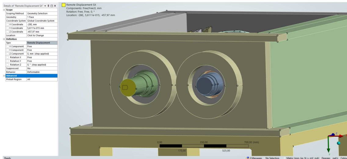
Figura 6.3: Configurazione AC: Remote Displacement all'estremità lato trasmissione di un albero, con rotazione attorno all'asse e traslazione assiale nulle.
