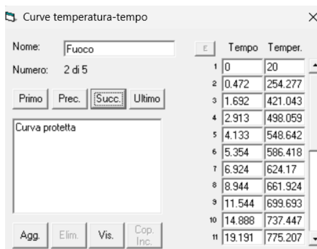
Figura 59 - Interfaccia grafica per definire le curve temperatura-tempo
