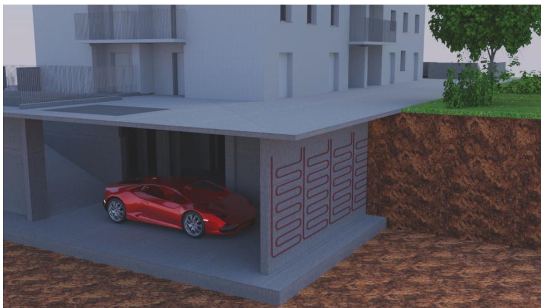
Figura 23: Esempio applicativo del sistema GeothermSkin sulla parete interrata di un edificio residenziale 2 .
