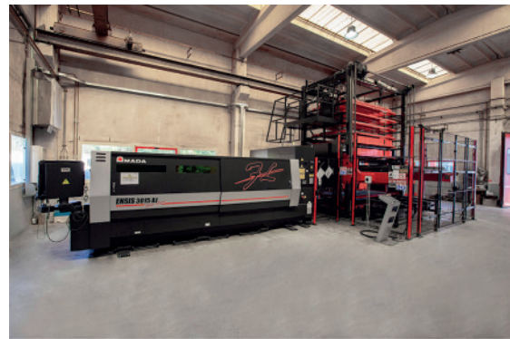
Fig. 1.5 Macchinario di taglio fibra e magazzino a torre
