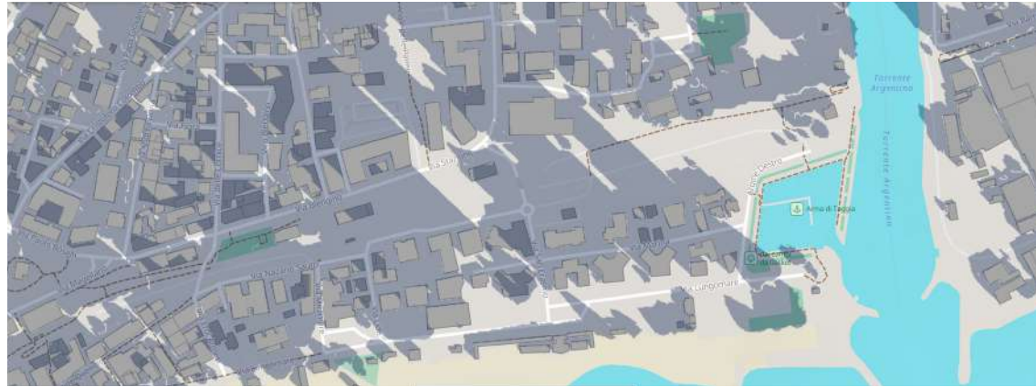
Fig. 25 Analisi delle ombre portate sul sito di Arma di Taggia al solstizio invernale (21 dicembre, ore 09:00 solari). Il sole raggiunge un'altitudine di 7.8° con azimut 133.5° S. Fonte: Shademap, elaborazione 2025.
