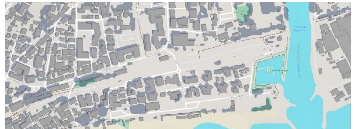
Fig. 28 Analisi delle ombre portate sul sito di Arma di Taggia al solstizio invernale (21 giugno, ore 12:00 solari). Il sole raggiunge un'altitudine di 62.5° con azimut 130.4° S. Fonte: Shademap, elaborazione 2025.
