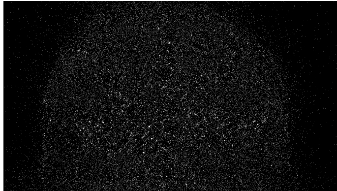
FIGURA 4.15: Esempio di pseudo-snapshot EBIV utilizzato come input per il processing PIV in PAIRS.
