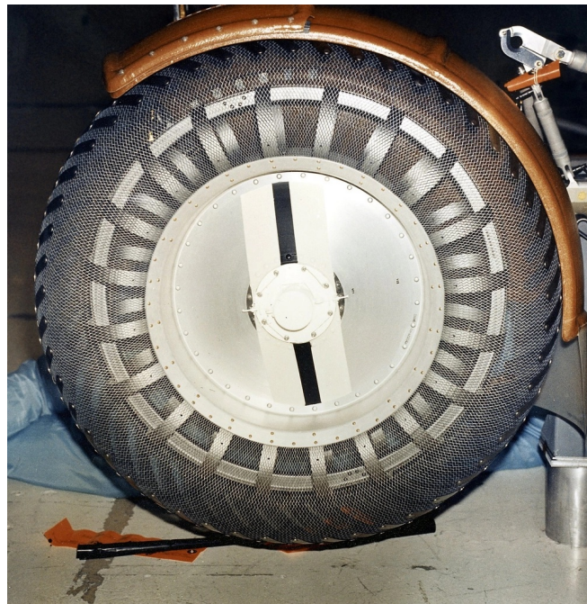
Figura 2.1: Ruota a rete metallica del Lunar Roving Vehicle Apollo; sono visibili la maglia deformabile e gli elementi di trazione. Immagine NASA, identificativo MSFC-7020255, di pubblico dominio [10].
