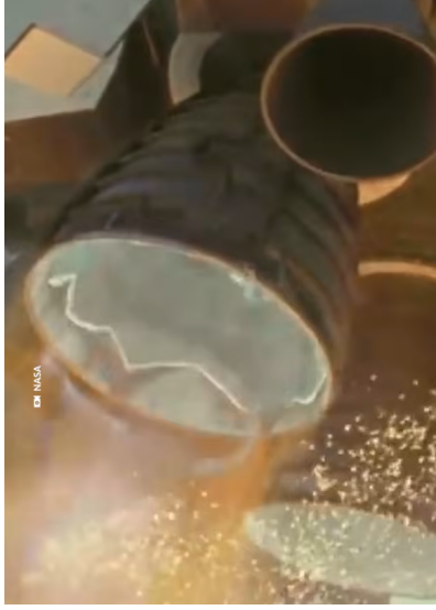
Figura 4: Istantanea di un motore SSME (Space Shuttle Main Engine) durante l'accensione. È ben visibile la linea di separazione (linea bianca) di forma irregolare.
