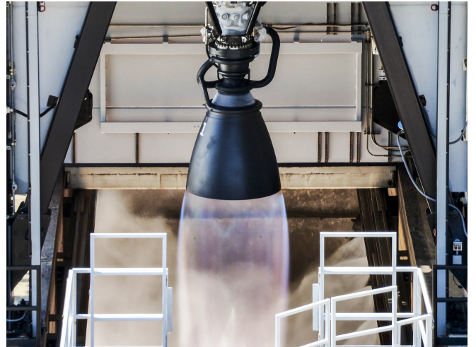
Figura 1: Rappresentazione schematica di un endoreattore [3](a), static fire test dell'endoreattore Raptor 3 di SpaceX (b)
