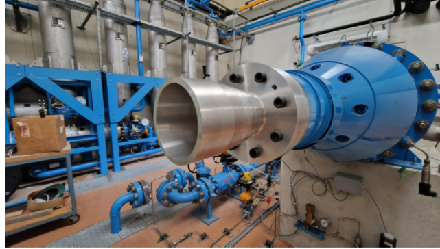
Figura 12: Apparato sperimentale per l'ugello TIC all'istituto PPRIME di Poitiers, Francia [2]
