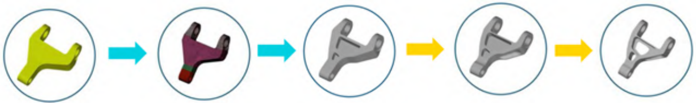
Figura III.1: esempio processo di ottimizzazione per una Bracket
