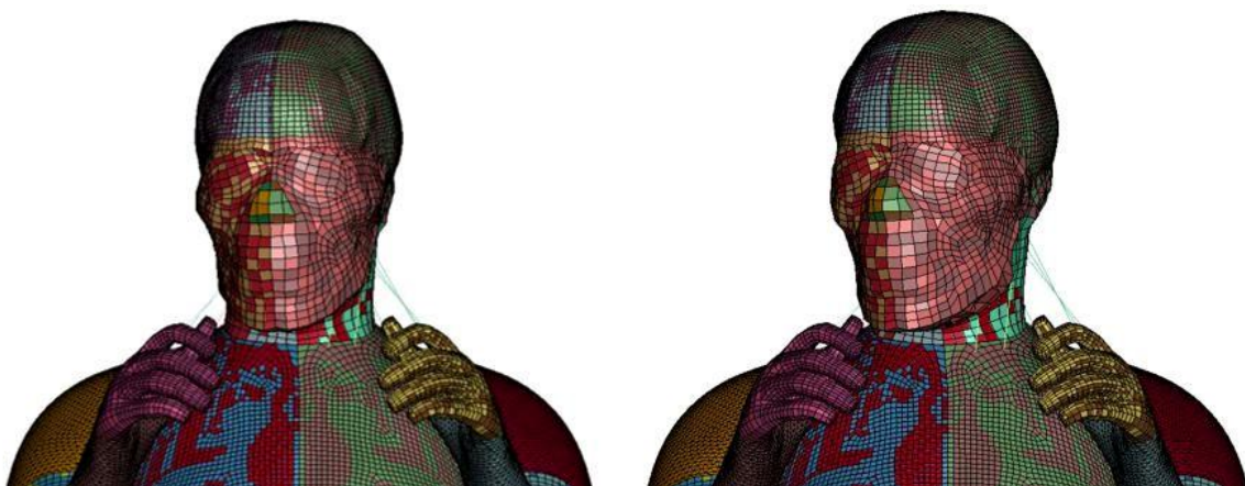
Figura 8. Confronto visivo geometry-based positioning : rotazione di 17^\circ (sinistra) e 56^\circ (destra)
