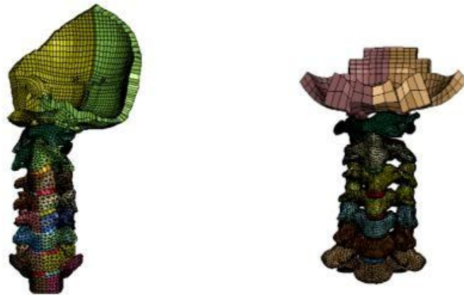
Figura 23. Confronto tra le componenti ossee del rachide cervicale e dell'occipite nelle configurazioni ottenute mediante posizionamento simulation-based con rotazione imposta pari a 56°: THUMS a sinistra, VIVA+ a destra
