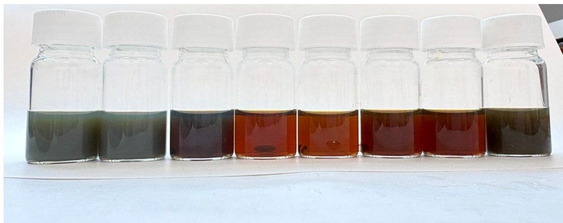
Figura 3.7: Nanoparticelle ottenute da sintesi a pH crescente, rispettivamente pari a 7.0, 8.0, 9.0, 10.0, 10.5, 11.0, 11.5, 12.0.
