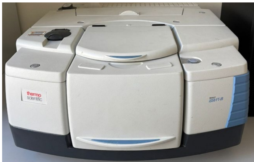
Figura 12: Spettrofotometro Thermo Scientific Nicolet™
