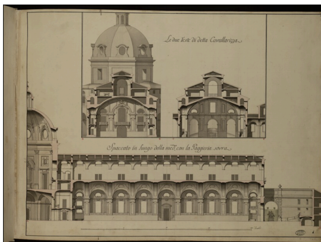
Figura 3. Disegno di progetto di Benedetto Alfieri per il nuovo maneggio della Cavalierizza Reale. La tavola comprende due sezioni trasversali e uno spaccato longitudinale che documentano l'organizzazione spaziale dell'edificio, con la grande aula coperta e la paggeria sovrastante. Archivio di Stato di Torino.
