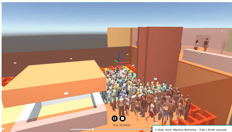
Figura 5. Simulazione di esodo; [Analisi della dinamica dell'incendio presso il locale “Le Costellation” - Crans-Montana, Arch. Martina Bellomia]
