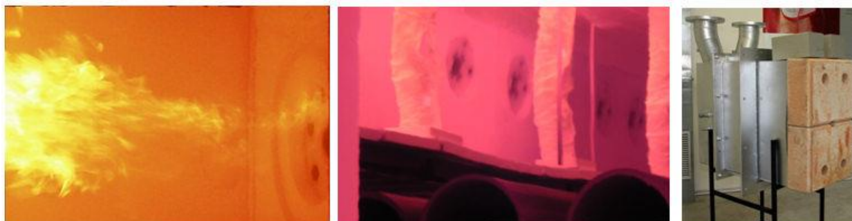
Figura 2.14: Bruciatori con fiamma visibile, flameless e rigenerativo
