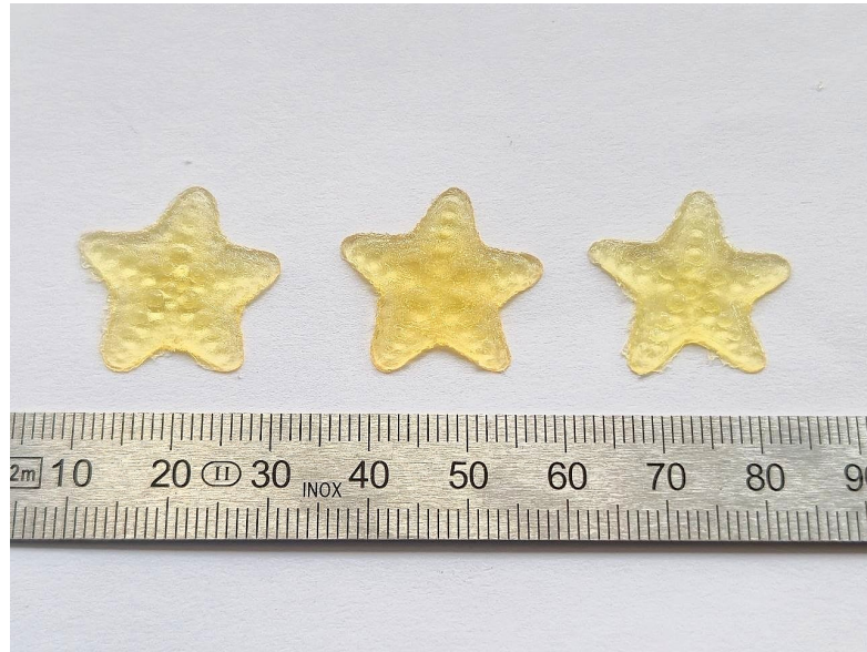
Figura 3.21: Stelle marine stampate: no CNC, 1phr CNC e 2phr CNC, da sinistra verso destra
