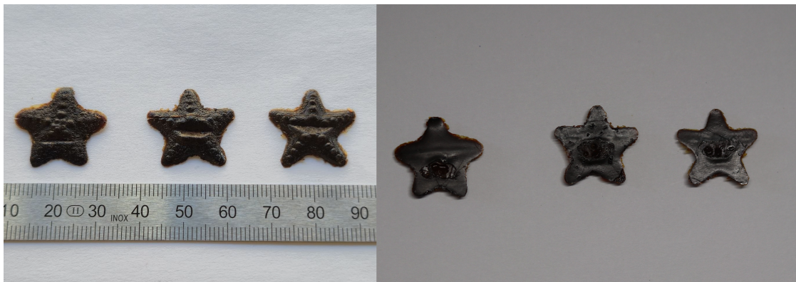
Figura 3.26: Stelle marine riprocessate: no CNC, 1phr CNC e 2phr CNC, da sinistra verso destra
