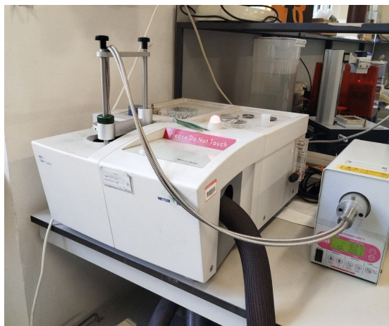
Figura 2.11: Mettler Toledo DSC-1 TM accoppiata con lampada UV Hamamatsu Lightningcure LC8-L9588 TM
