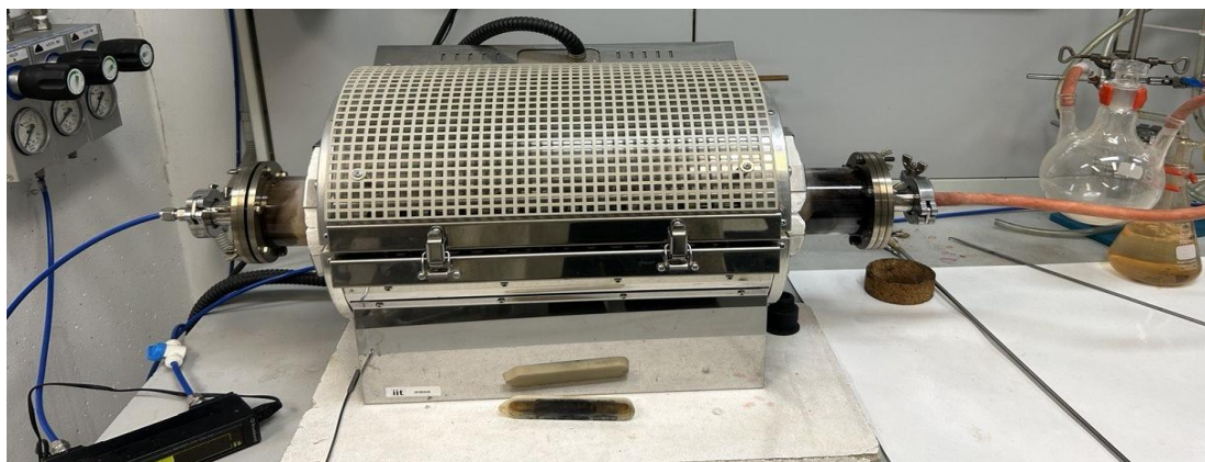
FIGURA 14 FORNO TUBOLARE IN QUARZO PER PIROLISI CON GRIGLIA DI COPERTURA SUPERIORE IN ACCIAIO INOX: AZIENDA EUROTHERM
