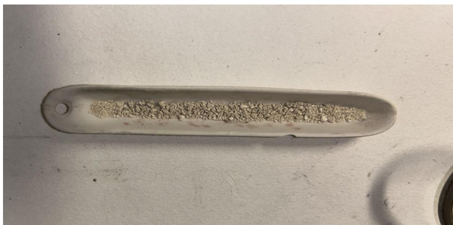
FIGURA 13 NAVETTA IN PORCELLANA PER PIROLISI ( 700^\circ\text{C} )
