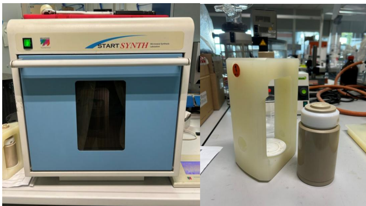
FIGURA 9 MICROWAVE SYNTHESIS LABSTATION (STAR SYNTH) EQUIPAGGIATO CON AUTOCLAVE IN TEFLON
