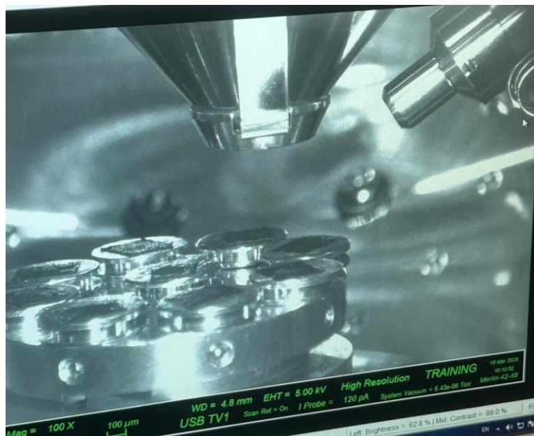
FIGURA 15. VISTA INTERNA DELLA CAMERA D'ANALISI DEL MICROSCOPIO ELETTRONICO A SCANSIONE (FESEM). IN PRIMO PIANO È VISIBILE LO STUB SAMPLE HOLDER MULTI-POSIZIONE CON I CAMPIONI DI POLVERE CATALITICA FISSATI SU NASTRO DI CARBONIO CONDUTTIVO
