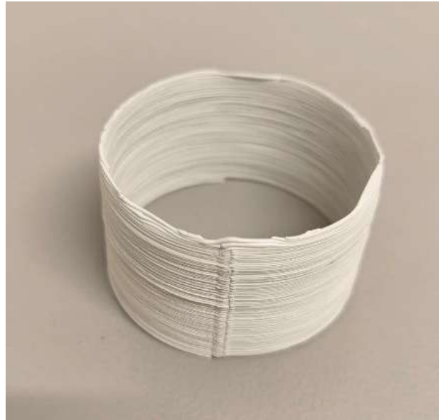
Figura 17: campione ottenuto mediante stampa LDM con pellet PLA-Al-80.
