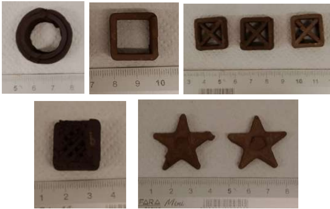
Figura 25: campioni di piccole dimensioni dopo il ciclo di debinding termico; in ordine: cilindro cavo, quadrato cavo, quadrati con diagonali 1, 2 e 3, quadrato con reticolo, stella 1 e stella 2
