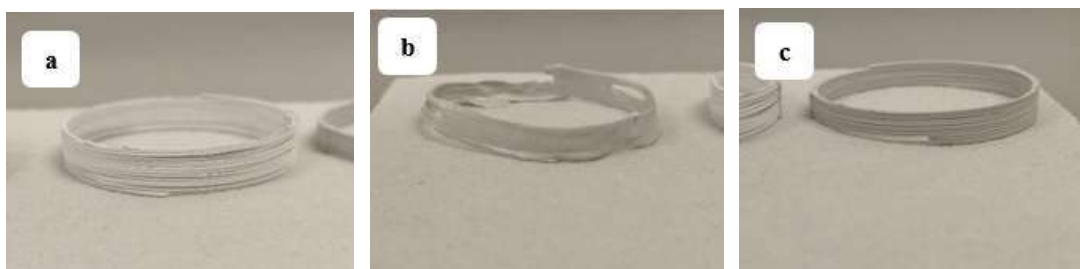
Figura 30: fotografia dei campioni in seguito al primo ciclo di debinding chimico; a) immersione in acetone, b) immersione in cloroformio, c) campione non trattato chimicamente
