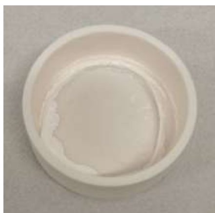
Figura 32: fotografia del campione b in seguito al primo ciclo di debinding multistep
