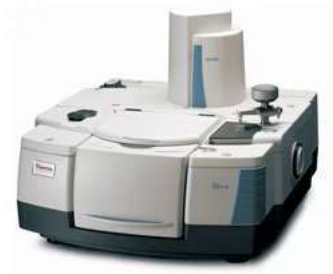
Figura 11: spettrometro FTIR Nicolet™ iS50 (Thermo Fisher Scientific Inc., USA) [47]
