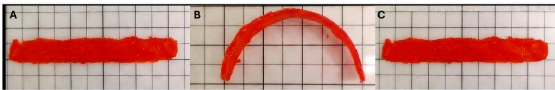
Figura 5.34: A) TMPTA4_15E_DR1 pre-deformazione, B) TMPTA4_15E_DR1 post-deformazione, C) TMPTA4_15E_DR1 post recovery in bagno termico
