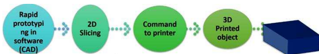
Figura 3.5: Schema generale dei processi di stampa 3D, tratto da (Alsha Subash, 2020)
