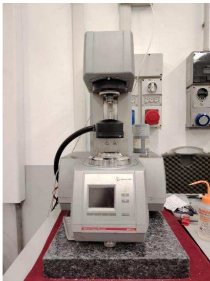
Figura 4.13: Reometro utilizzato durante l'attività sperimentale
