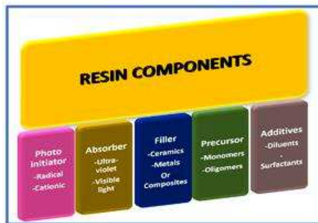
Figura 3.8: Componenti di una resina utilizzata per stampa tramite SLA, tratto da (Alsha Subash, 2020)
