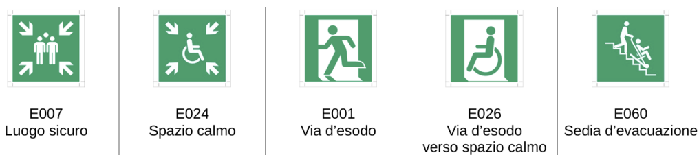
Figura 15: Esempi di segnali conformi alla norma UNI EN ISO 7010 posizionati lungo il percorso d'esodo
