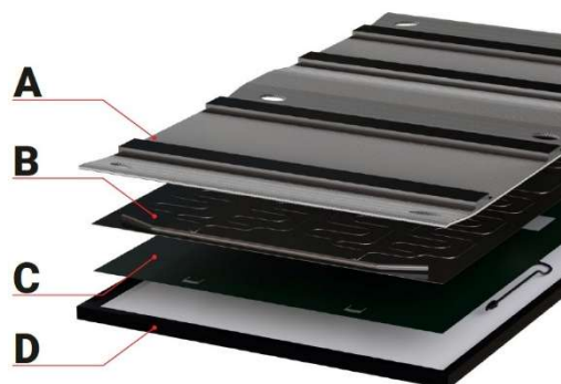
Figura 13: Struttura ABCD della Cellafredda
